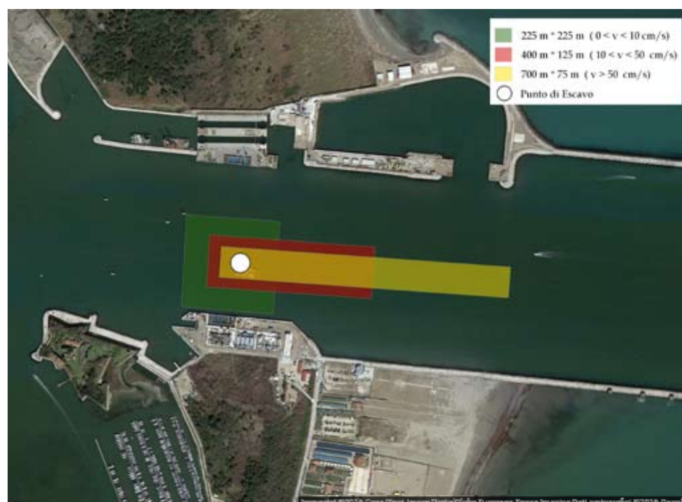
5. Esempio di forme dell'A.I.T. in funzione della velocità della corrente “v”, alla bocca di porto di Chioggia. Dati mappa ©2016 Google.
