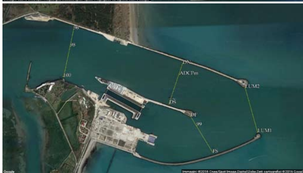
11. Sezioni caratteristiche e punti notevoli indagati nel corso dei 10 anni di monitoraggio alla bocca di porto di Malamocco. Dati mappa ©2016 Google.
