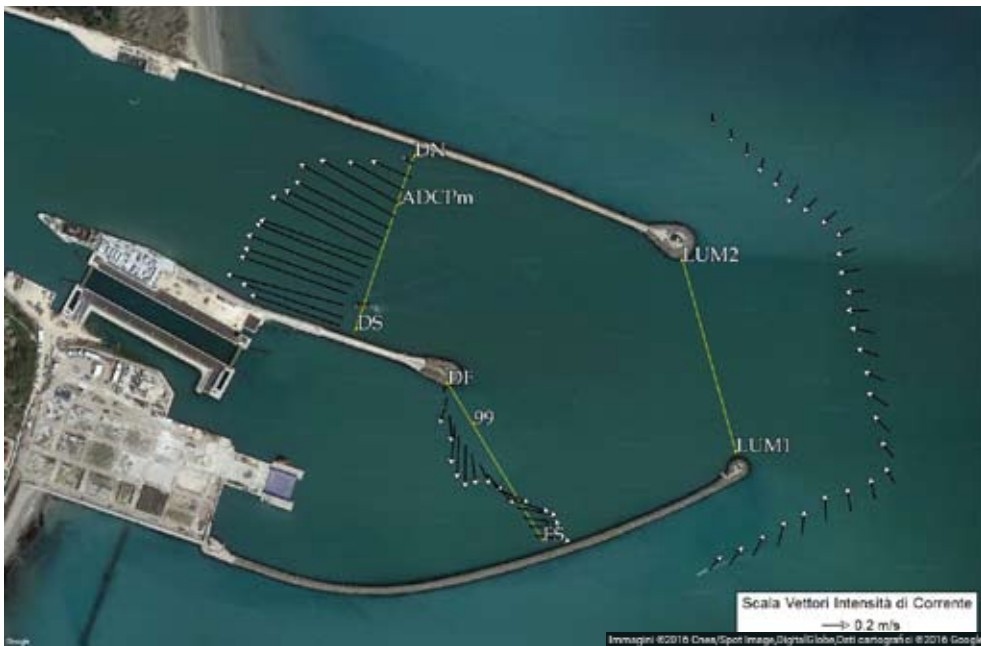
18. Configurazione del campo di corrente, come velocità media sulla verticale e direzione (evidenziate con vettori proporzionali all'intensità), presso la bocca di porto di Malamocco il giorno 4 ottobre 2013, con marea crescente. È evidente la struttura vorticoso all'interno del bacino di evoluzione della conca di navigazione. Dati mappa ©2016 Google.
